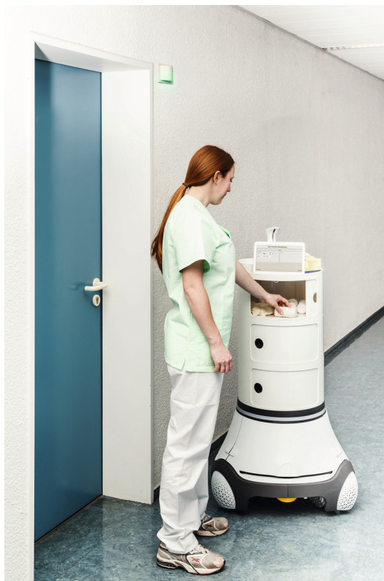
Der intelligente Pflegewagen fährt autonom zum Einsatzort. (Quelle: Fraunhofer IPA)
