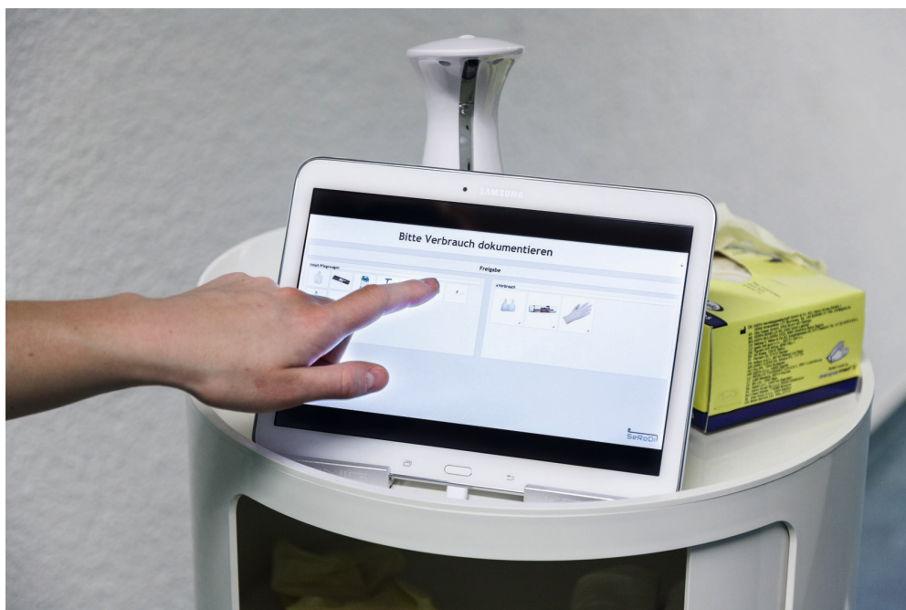
Über das Touchpad kann der Verbrauch an Pflegeutensilien dokumentiert werden. (Quelle: Fraunhofer IPA)
