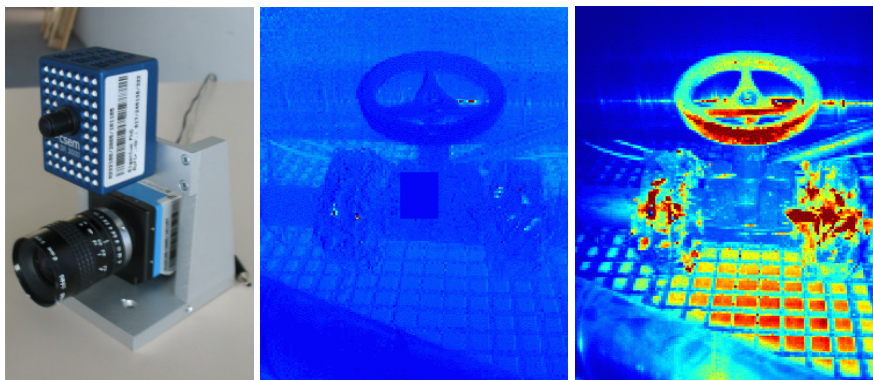
Bild 2 Sensoraufbau, Tiefen- und Intensitätsbild eines Handrads.
