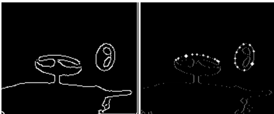
Bild 4 Kantenextraktion und zu Ellipsen gehörenden Bildpunkte
