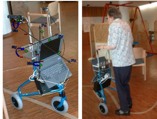
Bild 3 Testplattform für Kraft- und Momentenmessungen
